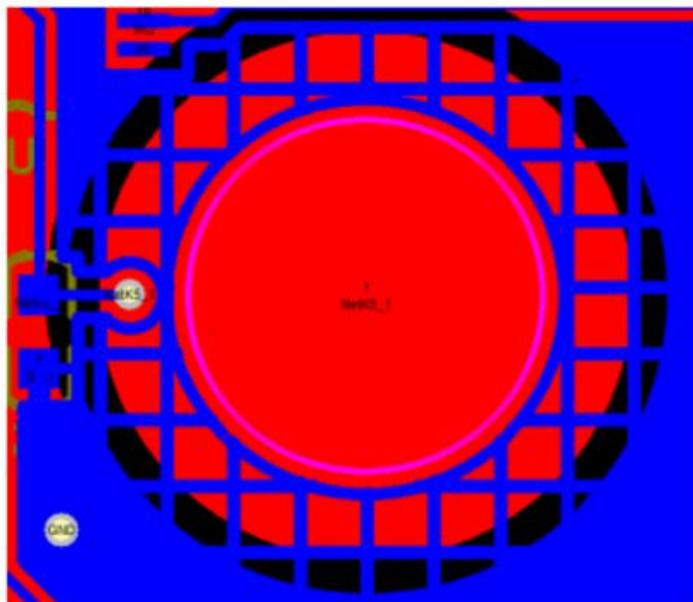
10) 通常 PCB 很少直接裸露开放给终端用户，而是在 PCB 的表面加上覆盖材料，以免用户直接接触电路板或电路板直接与外界环境接触。触控感应应用中的表面覆盖物一定不能为导体。当金属或其他导体物质放在两个导电 PAD 盘之间时，如手指与 PAD 之间，不能形成电容的电介质。请参考平板电容的电容值公式。绝缘介质的厚度会影响触控按键的感应能力，表面材料的厚度与灵敏度成反比，建议采用 2-4mm 厚度的介电常数较好的玻璃，亚克力等以维持良好的感应能力。绝缘介质跟 Pad 之间不建议存在空隙（远距例外）。
