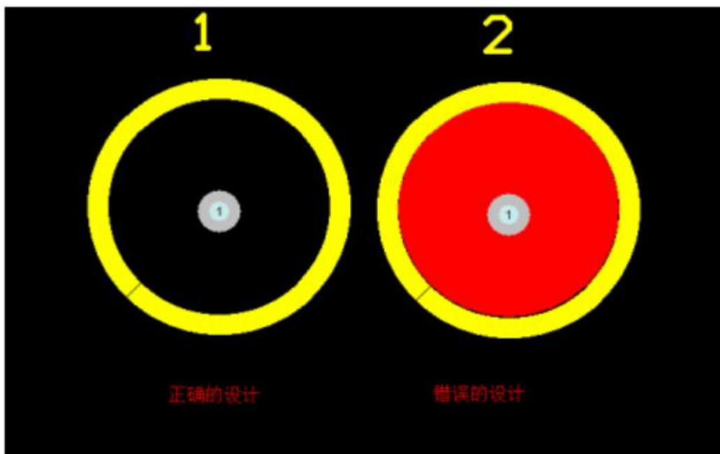
9) 在无铺地的情况下变动率能有较佳的表现。如果电路有铺地可能保持离触控 PAD 及其走线有 2MM 以上的间距，敷铜要保持完整性，不能留有孤铜存在（如下图）。
